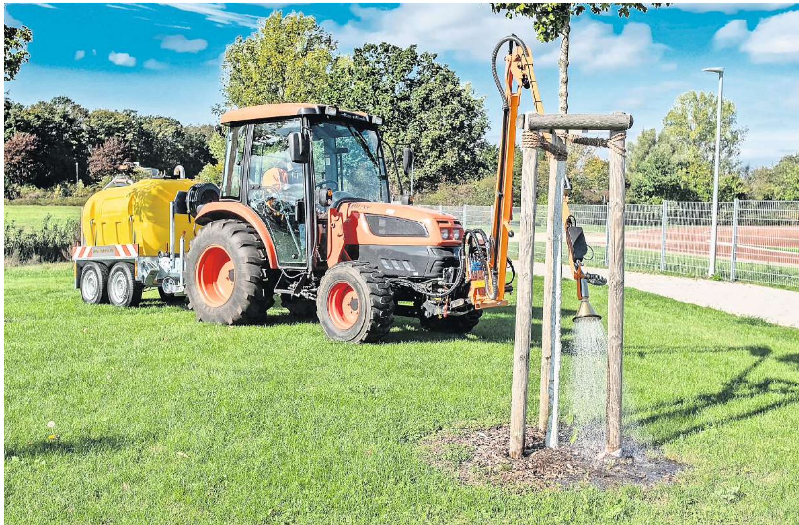
Zielgenau wässern: Der Trecker des Bauhofes gießt Bäume mit einem Gießarm, damit möglichst wenig Wasser verloren geht.
